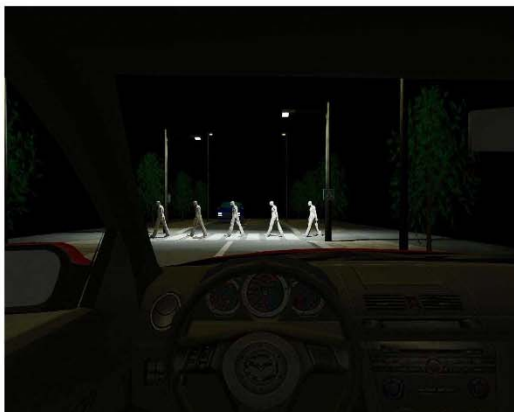
a) Nevhovující instalace (chodci v levé polovině přechodu splývají s pozadím)
